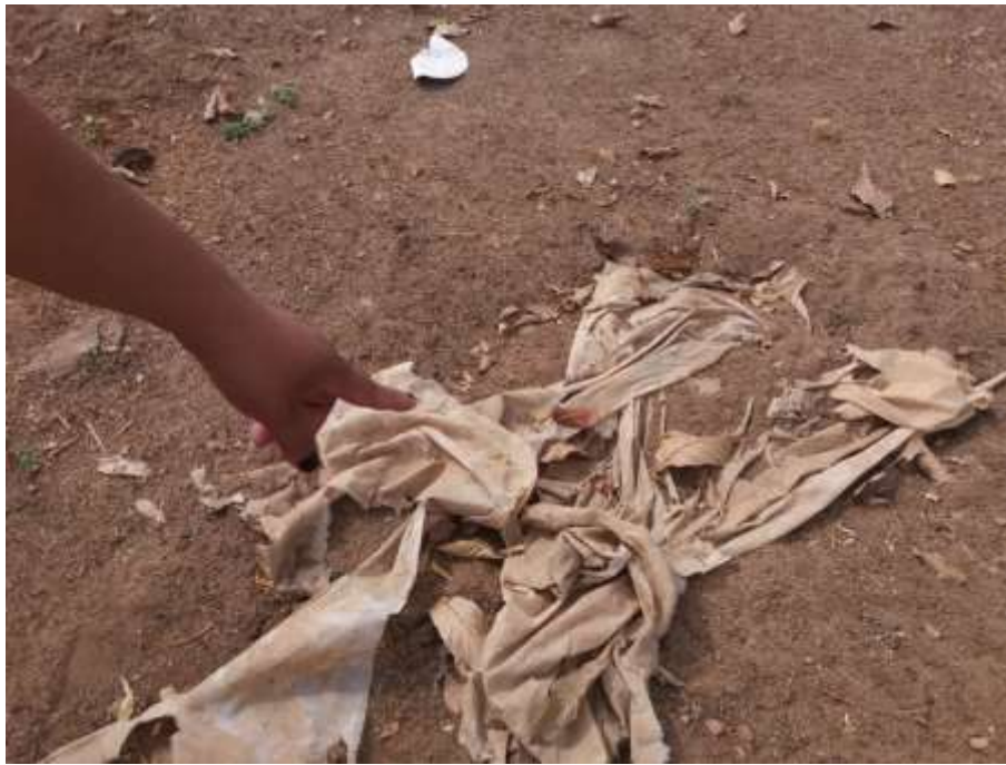
Figura 11– TNT usado em 2012 exposto e desgastado, Foto: Andreia Ravani.
